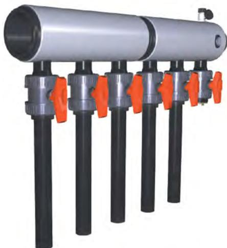
Colectores modulares fabricados en base a polietileno de alta densidad PE100 para conexión de sondas Ø40 y Ø50 (verticales) fabricadas en PE100 y con relación de diámetros SDR11. Conexión de dichas sondas mediante termofusión HS. Dotado de válvulas de bola. Incluye purgador R 1/2" y llave de llenado/vaciado. Dispone de dos orificios con rosca R1/2" con tapones para alojamiento de accesorios (p. ej. termómetro).
