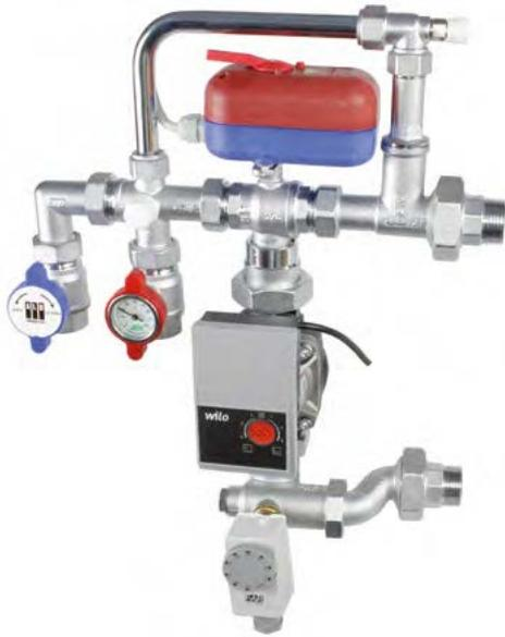
Este grupo de regulación modulante está indicado para el suministro de agua a baja temperatura a los circuitos de una instalación radiante. Incluye las conexiones de ida y retorno para el montaje directo a un colector de climatización radiante, así como las conexiones para la recepción de agua caliente y de retorno (estas últimas dotadas de llaves de corte de tipo esfera).
