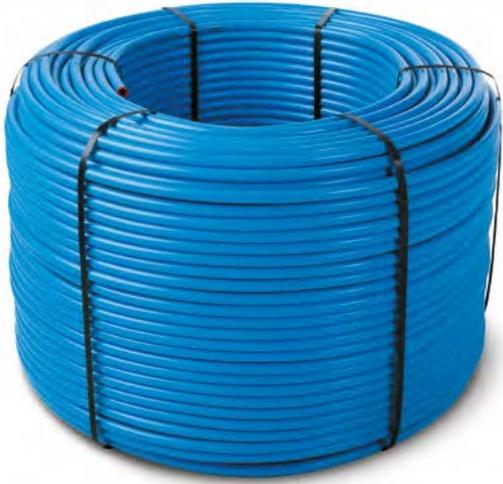
**APLICACIONES DOMÉSTICAS.** Tubo multicapa ALB azul para climatización radiante, 17 x 2; compuesto por una capa interior en polietileno PE-RT (DOWLEX 2388), una capa intermedia en aluminio de 0,2 mm de espesor, soldada a testa, y una capa exterior en polietileno (PE-RT). Presentación en rollos de 200 m ó de 500 m.
