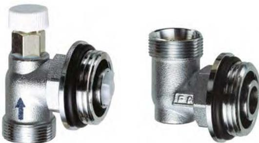
Consiste en dos elementos: un codo para el colector inferior, y un codo para el colector superior que incorpora la válvula reguladora propiamente dicha, más un purgador de aire manual. Ambos elementos incluyen juntas tóricas y conexiones roscadas 24 x 19, aptas para adaptadores para tubo multicapa. Presión diferencial de apertura 2 m.c.a. Su función es conectar el colector de ida con el de retorno en caso necesario, para realizar la recirculación.
