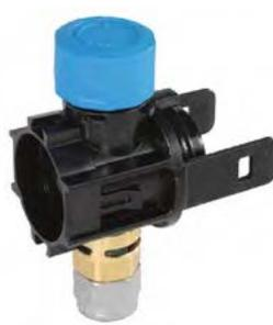
Módulo de ampliación de una vía para el colector premontado de plástico con caudalímetros. Módulo con válvula de corte para el colector de retorno. Incluye bicono intercambiable para tubo multicapa 16 x 2 mm. Derivaciones eurocono 1/2\".
