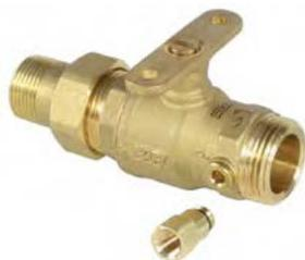
Las válvulas de zona de paso total se basan en el diseño de la válvula de bola, que proporciona una función de corte y de paso total en posición abierta, con giro de 90°. Estas válvulas se ofrecen en versiones de dos y de tres vías, en diversas configuraciones. Todas las versiones están preparadas para su motorización mediante un servomotor todo-nada.
