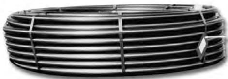
A utilizar conjuntamente con las sondas verticales. Fabricado en base a polietileno de alta densidad PE-HD, relación de diámetros SDR11 y PN16. Facilita la operación de llenado del pozo mediante la inyección en sentido ascendente del material de relleno, bentonita o similar.
