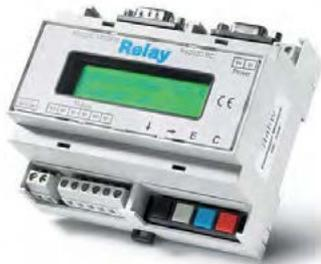
Concentrador de datos M-Bus hasta 20 viviendas, incluyendo registro de datos de contabilización de energía frío y calor, ACS y AFS. Módulo con display incorporado para visualización de lecturas. Requiere alimentador externo.
