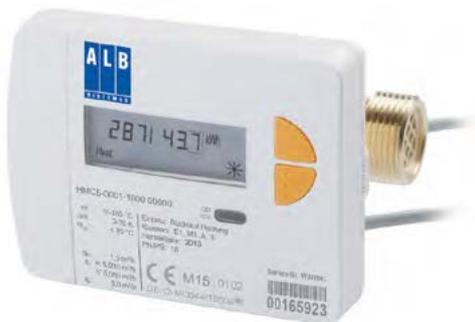
Contador de energía ALB de chorro simple, con aislamiento galvánico, para instalación vertical u horizontal, según MID 2004/22/CE Anexo MI-004. Módulo electrónico que permite la configuración del contador extraíble o no según referencia, con batería de 10 años de vida útil, incorpora sonda de impulsión y sonda de retorno preconectadas.
