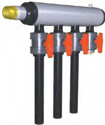
Colectores modulares fabricados en base a polietileno de alta densidad PE100 para conexión de sondas Ø40 (verticales) fabricadas en PE100 y con relación de diámetros SDR11. Conexión de dichas sondas mediante termofusión HS. Dotado de válvulas de bola. Incluye purgador R 1/2" y llave de llenado/vaciado.
