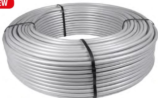
Tubo multicapa ALB para climatización radiante, 16 x 2; compuesto por una capa interior en polietileno PE-RT-I, una capa intermedia en aluminio soldada a testa, y una capa exterior en polietileno (PE-RT-I). Presentación en rollos de 200 m ó de 500 m.
