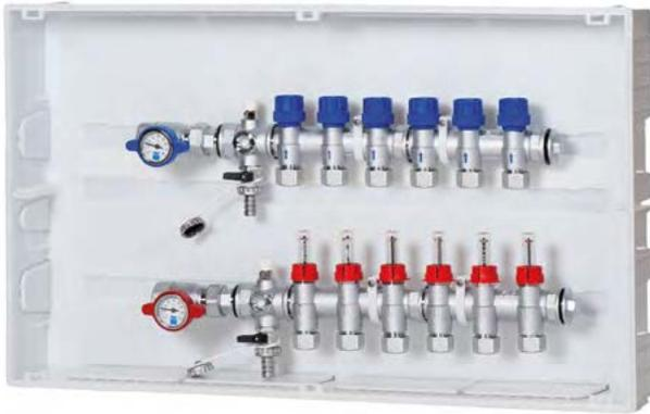
Colector premontado cromado de 1" H, de 3 a 12 vías, compuesto por un colector de ida con caudalímetros para la regulación y equilibrado de circuitos, y un colector de retorno con llaves de corte. Derivaciones 24 x 19, incluyen bicono intercambiable para tubo multicapa de 17 x 2 (mm); distancia entre derivaciones: 50 mm. Preparado para su automatización (incluye adaptadores en las llaves del colector de retorno para montaje directo de los cabezales).
