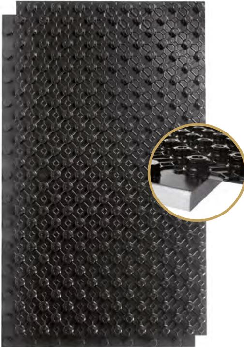
Panel aislante ALB con tetones, en poliestireno expandido, (EPS) autextinguible (Euroclase E), de 10, 18, 25, 40 ó 50 mm de espesor útil. Provisto de tetones moldeados para la fijación del tubo con separaciones en múltiplos de 50 mm, y perfiles perimetrales machihembrados para el montaje; con lámina de poliestireno termoformado, color negro, de 0,6 mm de espesor.
