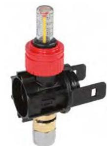
Módulo de ampliación de una vía para el colector premontado de plástico con caudalímetros. Módulo con caudalímetro para el colector de impulsión. Incluye bicono intercambiable para tubo multicapa 16 x 2 mm. Derivaciones eurocono 1/2\".
