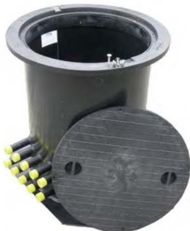
Arqueta para 5-12 sondas de geotermia con colectores incluidos. Completamente montada y lista para su colocación en obra. Fácil de instalar por un solo operario. Fabricada en PEHD (Polietileno de alta densidad), confiere al conjunto la robustez necesaria. Tapa transitable hasta 200kg certificada por TÜV, con bloqueo roscado, resistente al agua superficial y freática, con superficie antideslizante. Diámetro exterior 750mm. Diámetro interior 618mm (hasta 8 salidas) o 695mm (hasta 12 salidas).
