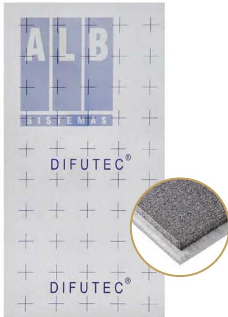
Panel aislante DIFUTEC®, fabricado en poliestireno expandido con grafito (EPS+grafito), autoextinguible (Euroclase E), de 40, 50 y 60 mm de espesor; está cubierto por una lámina superficial de aluminio, difusora del calor, de 0,25 mm de espesor, provista de solapas autoadhesivas y cuadrícula de guía serigrafiada.
