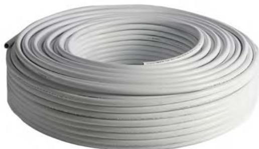
Tubo multicapa ALB para climatización radiante, 16 x 2; compuesto por una capa interior en polietileno PE-RT (DOWLEX 2388), una capa intermedia en aluminio de 0,2 mm de espesor, soldada a testa, y una capa exterior en polietileno (PE-RT). Presentación en rollos de 200 m ó de 500 m.
