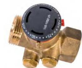
Válvula de equilibrado hidráulico dinámico. Es un regulador de caudal y presión que funciona de modo independiente y automático. Mantiene la presión diferencial a un valor constante una vez seleccionado un determinado caudal en el volante.
