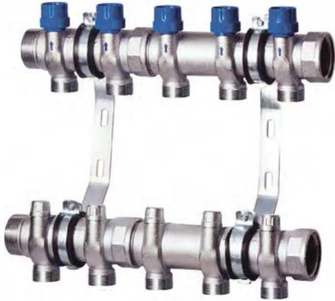
Colector premontado cromado de 1-1/2", de 2 a 12 vías, compuesto por un colector de ida con detentores para la regulación y equilibrado de circuitos, y un colector de retorno con llaves de corte.
