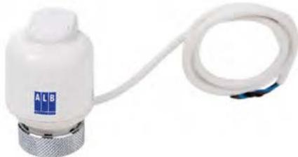
Cabezal termoeléctrico para montaje sobre válvula de corte en colector metálico; funcionamiento a 230 Vca ó a 24 Vca; normalmente cerrado.
