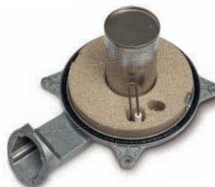
El quemador de premezcla y bajo NOx cuenta con un control de llama por ionización que permite adaptar la combustión modificando la relación de aire/gas con el fin de obtener las menores emisiones contaminantes independientemente de las condiciones ambientales o de instalación.
