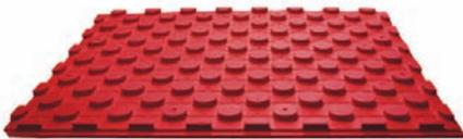
Panel de tetones de poliestireno plastificado (EPS) según norma UNE EN 1264.4 de 20 mm de espesor base y densidad media de 22 Kg/m<sup>3</sup> y de 20, 37 y 47 mm de espesor base y densidad de 27 Kg/m<sup>3</sup>. Provisto de tetones moldeados para la fijación del tubo con separaciones en múltiplos de 80 mm, con recubrimiento de film para evitar el apelmazamiento del aislamiento.
