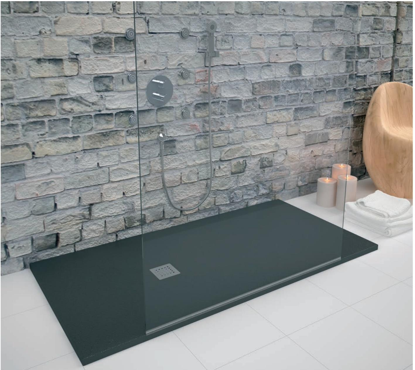
Los platos **STRATO** están compuestos por la mezcla de resinas con cargas minerales tintadas en masa y con una superficie de acabado final compuesta por un componente protector denominado gel coat (resinas modificadas que se aplican en estado líquido), que refuerza su durabilidad, protección anti-bacterias, hongos, rayos ultravioletas y una buena protección ante el desgaste.
