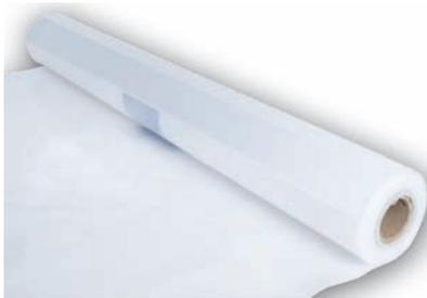
Película de polietileno de baja densidad que se coloca debajo del panel aislante, particularmente en plantas en contacto directo sobre el terreno, o que pueden absorber humedad. Su función es evitar que la eventual humedad del suelo, bien directamente, bien en forma de vapor, alcance el mortero del suelo radiante y pueda llegar a degradarlo.
