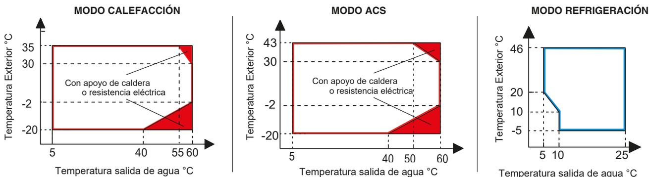
**NOTA PARA MODO ACS:** La temperatura de salida de agua indicada en la tabla es la temperatura del agua producida a la salida del equipo, y no coincide con la temperatura de ACS disponible para el usuario en depósito de ACS, que dependerá del tipo de instalación realizada y de las características del serpentín del depósito de ACS.
