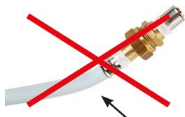
**7. PRECAUCIÓN.** Se deberá respetar un mínimo de  $1 \times D$  (diámetro exterior del tubo) entre la unión y las sucesivas curvas.
