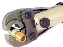
**4. COLOCAR EL CONJUNTO DE ACCESORIO Y TUBO EN LA MORDAZA**, la cual deberá estar sobre una prensa manual o eléctrica. El casquillo del accesorio se monta sobre las cunas de la mordaza. Solo una mordaza limpia y en buen estado asegura un correcto montaje.
