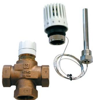
Conjunto diseñado para el control de la temperatura de impulsión en un sistema de calefacción por suelo radiante. Se instala justo antes del circulador de calefacción (no incluido). Cuerpo de la válvula fabricado en bronce rojo, partes interiores en latón y asiento de EPDM. Accionador termostático M30 x 1,5 mm con sonda de 2 metros y vaina de inmersión.
