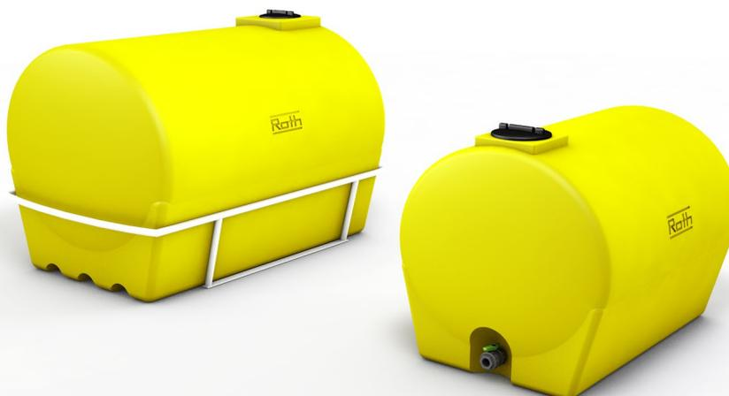
Depósito monobloque diseñado con forma horizontal para **almacenamiento y transporte de líquidos** (productos alimentarios, químicos\*, ácidos, etc.). Moldeado de una sola pieza, sin pegamento ni soldadura, por lo tanto **perfectamente estanco**. Excelente **resistencia a los choques**, gran robustez de las cubas. Superficie
