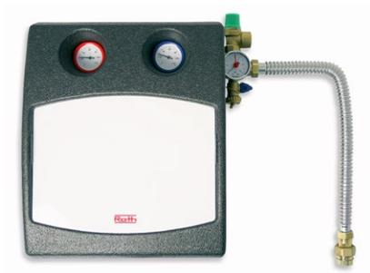
Unidad premontada con toda la valvulería necesaria, integrada en carcasa de EPP, altamente resistente con grupo de purga incluido. Formada por grifo de bola con válvula anti-retorno integrada, fijación a pared, grupo de seguridad con válvula de seguridad a 6 bar, manómetro solar de 0 a 6 bar, llaves de esfera de llenado y vaciado, incluidos elementos de montaje, circulador de alta eficiencia WILO Yonos Para ST 25/7,5 PWM2 cableado y probado.
