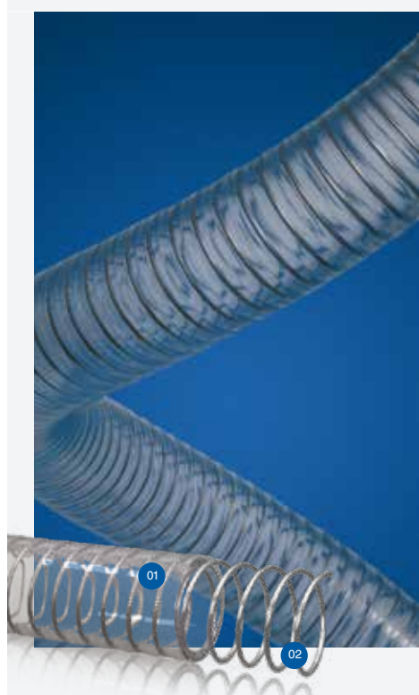
01.-Espiral recubierta de material de PVC flexible, transparente de uso alimentario. 02.-Reforzada en su interior por una espiral rígida metálica en acero galvanizado.
