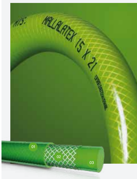
01.-Capa exterior de material tacto latex. 02.-Capa intermedia: reforzada con malla de hilo de poliéster. 03.-Capa interior de látex de uso alimentario.
