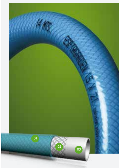
01.-Capa exterior pvc azul anti torsión y antidobleces. 02.-Capa intermedia: refuerzo con malla de hilo de poliéster para dotarla de la mayor resistencia. 03.-Capa interior blanca de uso alimentario y anti-algas.
