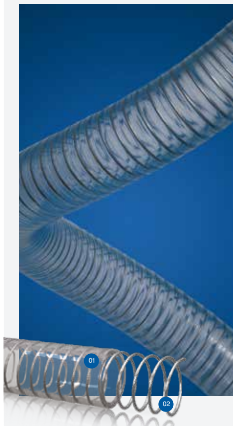
01.-Espiral recubierta de material de PVC flexible, transparente de uso alimentario. 02.-Reforzada en su interior por una espiral rígida metálica en acero galvanizado.
