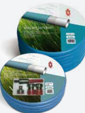
01.-Capa exterior pvc azul anti torsión y antidobleces. 02.-Capa intermedia: refuerzo con malla de hilo de poliéster para dotarla de la mayor resistencia. 03.-Capa interior blanca de uso alimentario y anti-algas.
